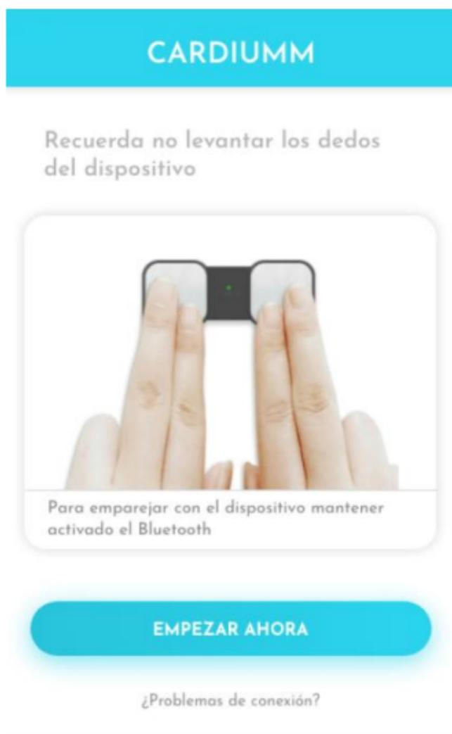
5. Coloque el dedo índice y el medio de una mano en un electrodo y el dedo índice y el medio de la otra mano en el otro electrodo, tal y como se muestra en la siguiente figura.
